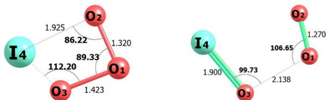
Figura 30 – Geometria inicial e geometria final da otimização do ponto de partida I, considerando-se fase gasosa e estado singlete, utilizando a base G.
